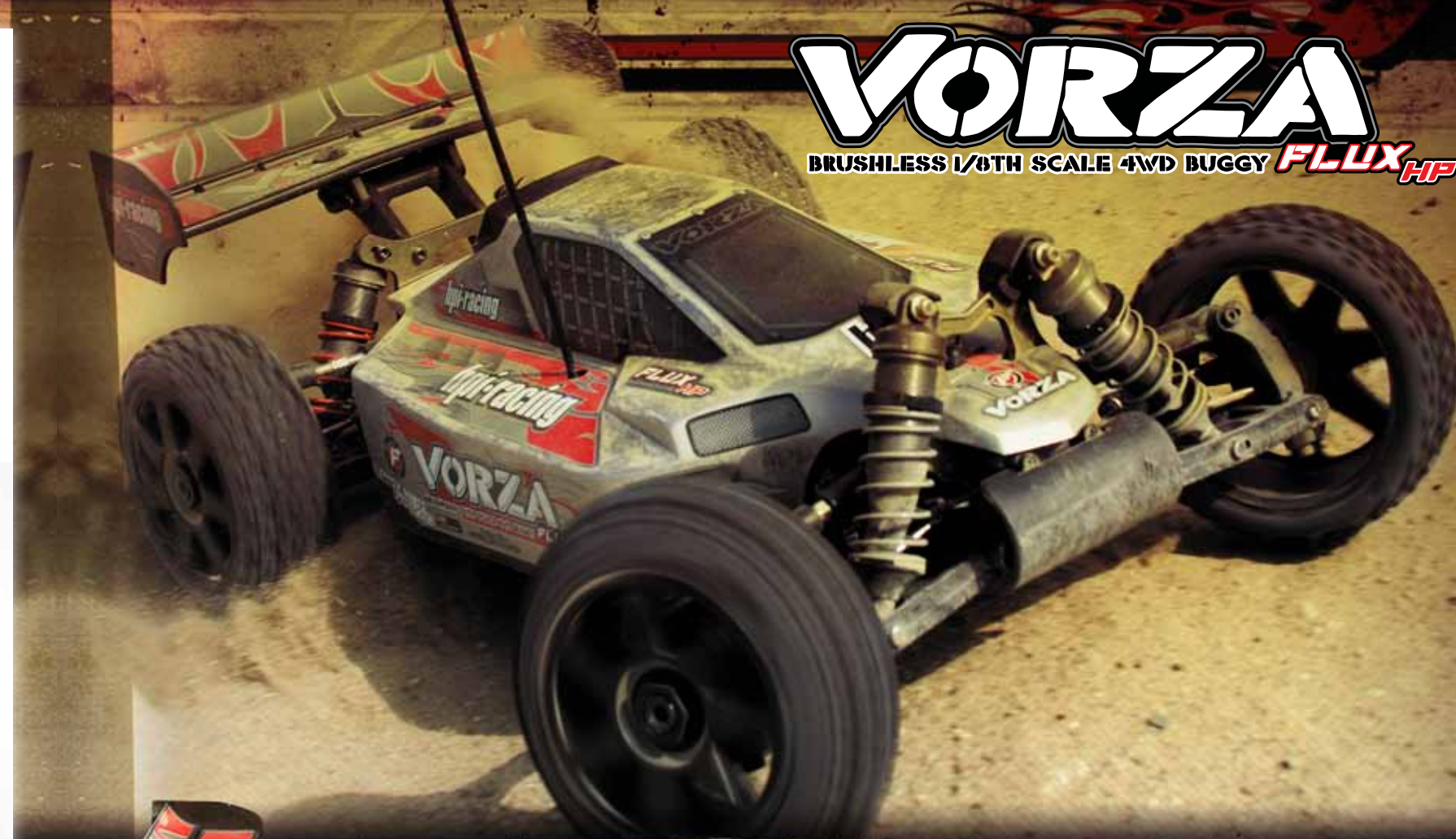
Brachial starker Flux Torq 2200kv bürstenloser Motor Akkualter für 4S oder 6S Lipo-Akkus 16mm "Big Bore" Aluminium-Dämpfer
