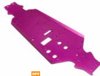
H101122 - Chassis 3mm (7075 Aluminium/eloxiert)
