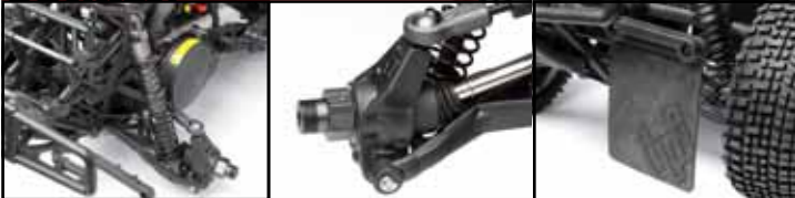
Extralange Aluminiumdämpfer vorne und hinten aus dem Baja 5S | Neue einteilige Radträger hinten, dickere Antriebswellen und Getriebeausgänge | Cooler und realistischer Schlammschutz
