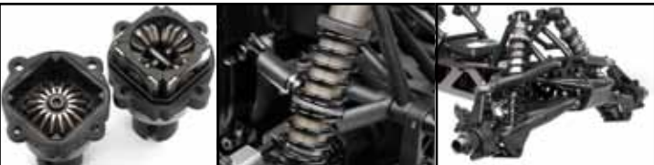
Robuste Kegelraddifferentialie | Optimale Fahreigenschaften durch zwei verschiedene Federhärten | Einzigartige, extrem langhubige Aufhängung
