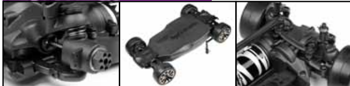
Vorderradantrieb mit Stahlantriebswellen
