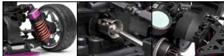
Komplett kugelgelagert | Stahl-Antriebswellen und Ausgänge | Massive Stahl-Kupplungsglocke und geschütztes Hauptzahnrad
