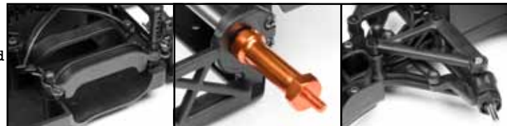
Die Akkuhalterung nimmt 4- oder 6- Zellen NiMh Stick Akkus oder runde 2S Lipo Akkus auf
