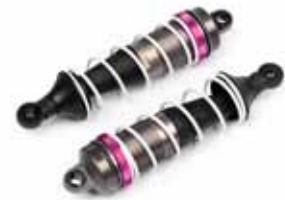
H101115 - "Big Bore" Alustoßdämpfer vorne
